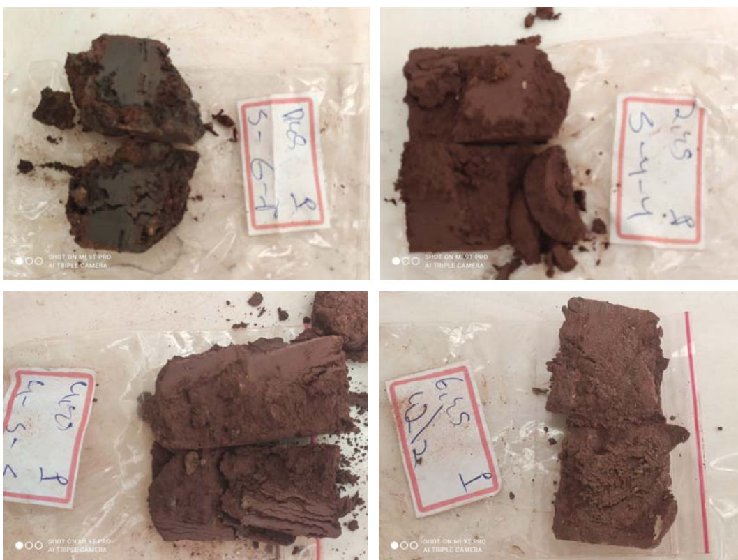
Fotos 06 a 09 – No alto, da esquerda para a direita = a) solo coluvionar, argiloso, pouco compacto; b) e c) solo residual de basaltos, argiloso, com textura maciça e d) solo residual produzido pela decomposição de rochas vulcânicas, com textura de fluxo de lavas, compacto. Fotos do autor.
